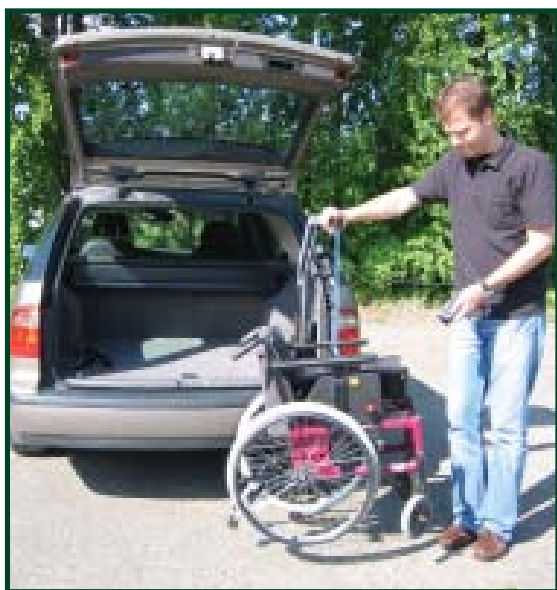
Carolift 90 kann für motorisierte oder handbetriebene Rollstühle bis zu 90 kg Gewicht benutzt werden.
